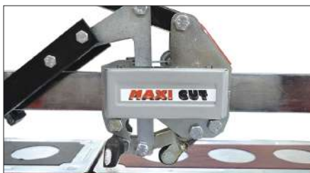
Механизм каретки состоит из 13 скрытых шарикоподшипников.
